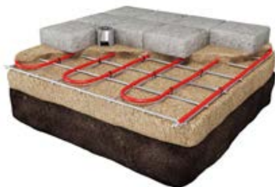
Montare în pat de nisip sub pavaj
