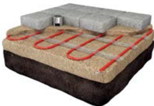
Montare sub pavaj
