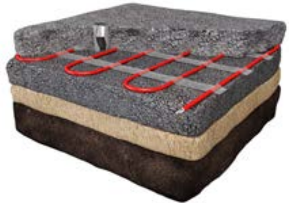
Montare în asfalt derulat
