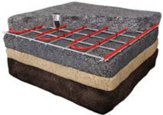
Montare în asfalt derulat
